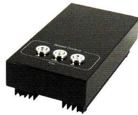
Внешний блок питания позволяет изменять скорость электронным способом – для запуска достаточно нажать на символ с нужным значением скорости, а для остановки предусмотрена специальная кнопка. Правда, электронного торможения не предусмотрено, поэтому массивный диск останавливается долго
