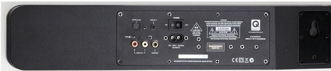
Мини-джек и RCA работают как один линейный вход. Предусмотрен оптический вход. Панель не углублена, потому что находится на скошенной задней плоскости и не мешает настенному креплению
