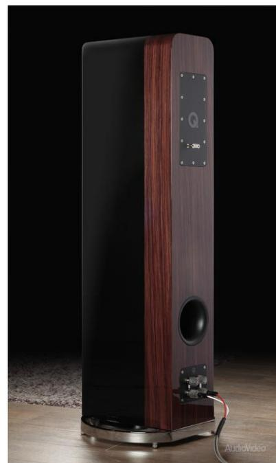
Корпус имеет закруглённые горизонтальные ребра, порт фазоинвертора внушительного сечения выведен назад. В комплекте имеются поролоновые заглушки, с помощью которых можно либо сузить выходной канал, либо совсем перекрыть его. Это тонкий инструмент настройки, позволяющий решить возможные проблемы с басом при установке АС вплотную к стене или в углу.
