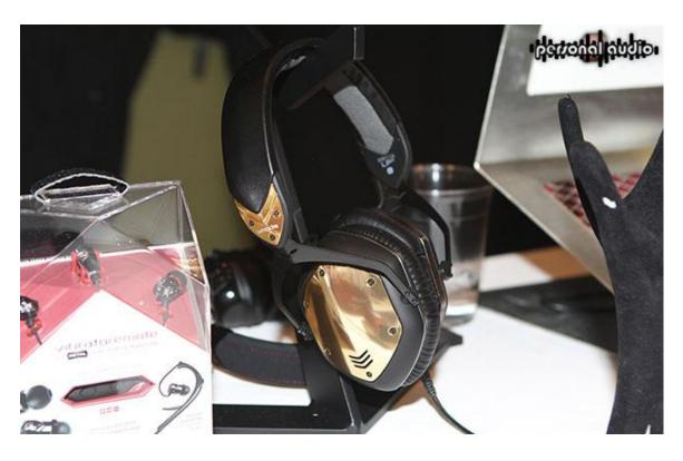
Динамик у V-Moda Crossfade LP2 50 мм. с двойной мембраной, сделанные по технологии Dual-Diaphragm (кольца диафрагмы разной жесткости). Скорее всего, речь идет о аналоге технологии <u>Varimotion technology</u> от AKG, где внутренняя часть (колпачок) имеет переменную толщину от 20 до 40 мкм, а подвес постоянную толщину в 20 мкм. Такая конструкция позволяет выровнять частотный баланс и снизить искажения.
