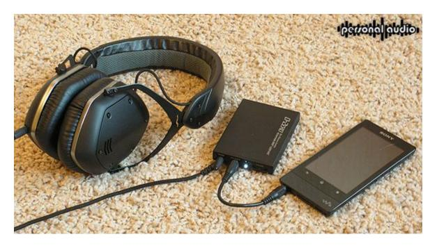
От плеера Sony наушники обеспечивают адекватную громкость, но без запаса по громкости. Другими словами, если источник звука будет еще слабее, то внешний усилитель будет обязательным. При подключении портативного усилителя iBasso D-Zero запас по громкости был достаточный.
