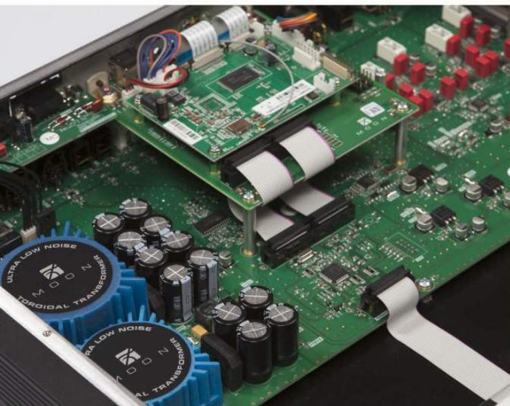
за USB-подключение отвечает XMOS. Преобразование частоты дискретизации возложено на SRC4392, а непосредственно цифро-аналоговое преобразование выполняется по-средством ES9016.
