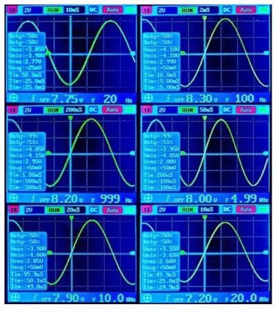
Используя **ламповый выход,** можно достичь максимальной громкости без видимых искажений. Результат 2.74 В и 180 мА дает мощность 0.5 Вт. Исключительно!
