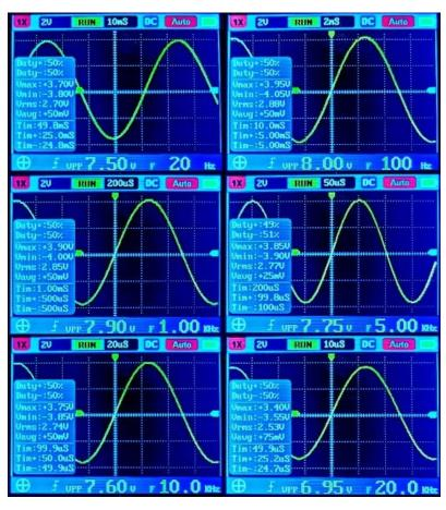
Используя **ламповый выход**, можно достичь максимальной громкости без видимой дисторсии. Результат 2.85 В и 250 мВт. Очень хорошо.
