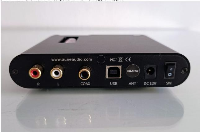
Bluetooth-версия позволяет использовать Flamingo как приемник, поддерживается aptX HD or LDAC.
