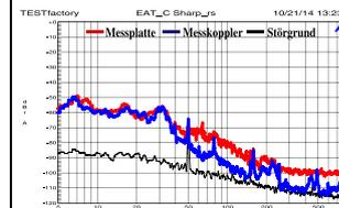
Im Nutzbereich sehr geringe Störungen, im Infrarot minimal höher
