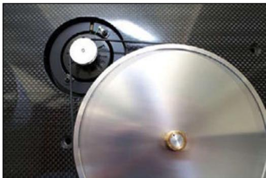
Der Subteller des C-Sharp wiegt etwa ein Kilogramm und besitzt mittig einen dicken Zapfen, der zur Zentrierung des eigentlichen Plattentellers dient. Das Lager selbst ist ein sogenanntes Inverslager, dessen tragende Keramik­kugel am oberen Ende der Achse angeordnet ist.
