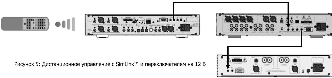
Рисунок 5: Дистанционное управление с SimLink™ и переключателем на 12 В
