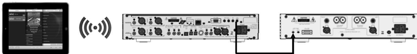
Рисунок 3: Дистанционное управление с переключателем на 12 В
