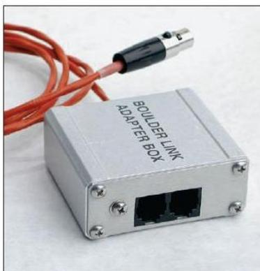
Если Вы используете предварительный усилитель Boulder 810 с другими устройствами производства Boulder, для их соединения необходим адаптер Boulder Link Adapter Box (BLAB). Хотя разъёмы отличаются у приборов разных линеек, их устройство идентично, что позволяет соединять между собой разные серии.
