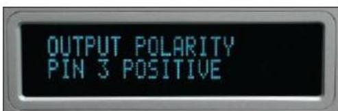
Полярность основных выходных разъёмов можно изменять для соответствия используемым оконечным усилителям. Для усилителей серий Boulder 1000 и 2000 должен быть выбран вариант “PIN 2 POSITIVE.” Для усилителей серий Boulder 100, 250 и 500
