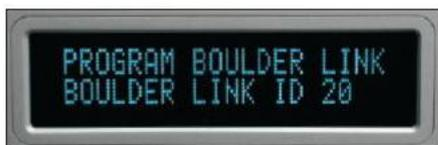
Каждое из подключенных к сети устройств должно иметь свой уникальный идентификационный номер Boulderlink. Идентификационному номеру предварительного усилителя Boulder 810 задано значение 20 - по умолчанию и/или в том случае, если производится сброс параметров.
