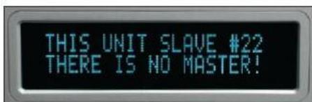
Когда все компоненты соединены кабелем Boulderlink и включены в сеть, нажатие кнопки STANDBY предварительного усилителя запустит последовательное включение всех компонентов. Сначала включится устройство "MASTER", то есть предварительный усилитель Boulder 810. После включения он произведёт поиск подключенных к нему компонентов. По мере их нахождения на экран будут выводиться идентификационные номера всех обнаруженных устройств.
