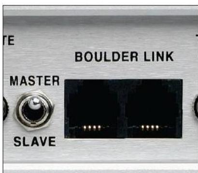
Каждая цепь устройств Boulderlink должна иметь одно и только одно устройство со статусом "MASTER". В большинстве случаев этим устройством является предварительный усилитель. Оконечные усилители мощности и другие устройства, не имеющие переключателя MASTER/SLAVE не могут иметь статус "MASTER." На предварительном усилителе Boulder 810, переключатель Boulderlink MASTER/SLAVE обычно установлен в позицию MASTER.
