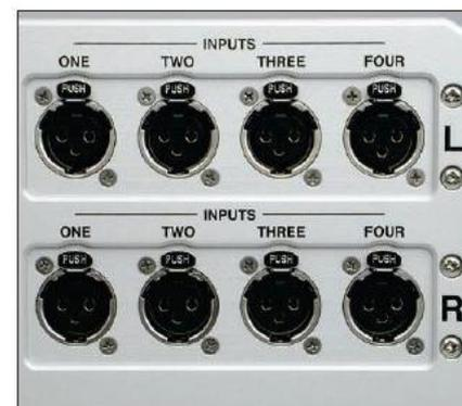
источника звука, что сокращает протяженность заземления. Также Вы можете подключить небалансный источник с помощью входного адаптера Boulder ABL. Он преобразует симметрический разъём в небалансный RCA непосредственно на задней панели предварительного усилителя. Как и у специального кабеля, третий контакт
